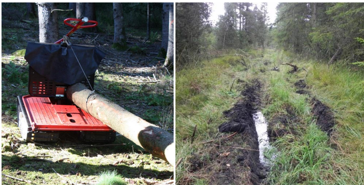
Abbildung 5, links : Das „Eiserne Pferd“, ein kleines Rückegerät für schwieriges Gelände mit Seilwinde und bodenschonendem Raupenfahrwerk; Rechts : Beschädigung einer Rückegasse auf Moorboden durch das Befahren mit schwerem Gerät und zu schmaler Bereifung
